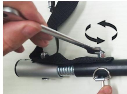
**1. Dévissez le support d'attache rapide, et retirez la vis qui traverse le tube de la remorque.**
