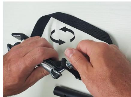
**3. Dévisser l'écrou de l'adaptateur remorque vélo sur cadre pour axe traversant.**
