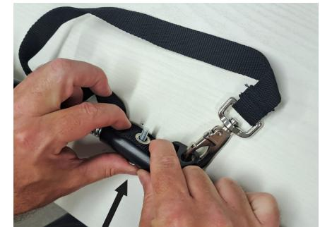
**5. Insérez la vis et revisser l'écrou pour verrouiller l'adaptateur.**
