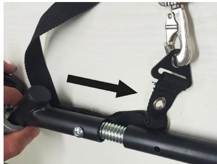
**4. Insérez l'adaptateur dans le tube de la remorque.**
