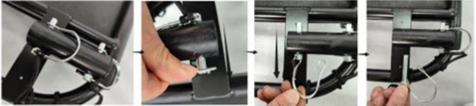
Ensuite, poussez la barre de remorquage dans le tube prévu à cet effet sur le côté gauche. Fixez la barre de remorquage insérée à l'aide des deux goupilles de dégagement rapide. Le coude de la barre de remorquage est maintenant orienté vers la droite par rapport au sens de la marche. *Important : Assurez-vous que la goupille est bien verrouillée, car une barre de remorquage desserrée pourrait vous faire perdre le contrôle de la remorque pendant la conduite.*
