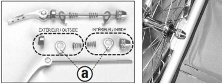
Prenez une roue et positionnez-la dans le guide prévu dans le châssis de manière à ce que le levier du vérin de tension rapide soit situé à l'extérieur de la remorque.
