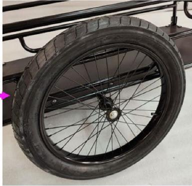
Placer l'axe de la roue dans le tube du cadre et s'assurer que la roue est correctement bloquée.
