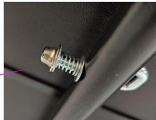
Démonter les roues : appuyer sur le bouton situé sous le châssis de la remorque et sortir la roue du tube du châssis.
