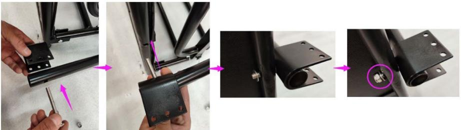
Monter la partie supérieure de la barre de remorquage à l'aide de la vis et de l'écrou papillon en suivant les étapes suivantes, s'assurer que la rondelle est
