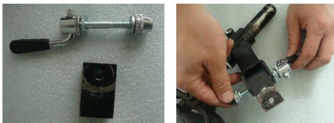
7. Connecter la barre de remorquage (2) avec le vélo en utilisant le système de fixation rapide comme indiqué sur les images ci-dessous :
