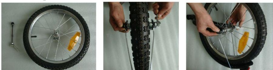
3. Connecter le cadre de chargement (1) et la fourche avec la roue par l'écrou de connexion (10) comme sur les images ci-dessous :
